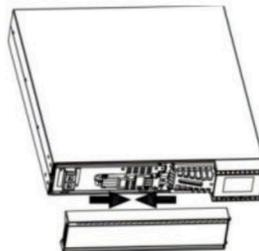
Conecte la entrada AC y reconecte las conexiones de las baterías.
